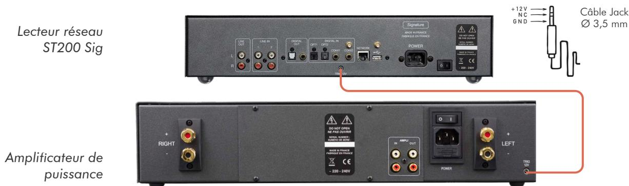
Afin que le système soit opérant, le bouton Marche/Arrêt de l'amplificateur doit impérativement rester en position Éteinte (0). Si l'interrupteur est en position Marche (1), celui-ci fonctionnera mais pas la fonction Trigger.
